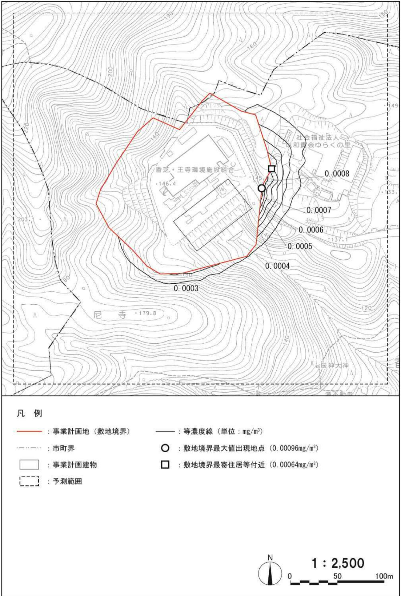
図 4.1-16 建設機械の稼働に伴う大気質予測結果 (浮遊粒子状物質)
